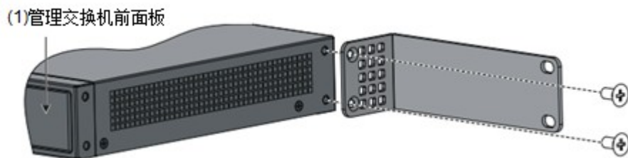
图4-14 挂耳安装到管理交换机电源侧示意图
